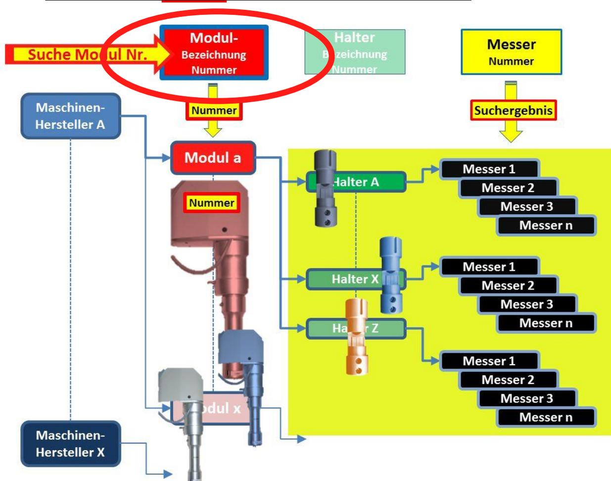
Als Suchergebnis werden diejenigen Messer angezeigt, die in alle für dieses Modul geeigneten Halter passen!
